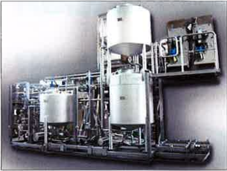
Um kurze Umstellzeiten bei Mars einzuhalten, wurde die Anlage fertig montiert geliefert (Bild: Gebr. Rieger)
